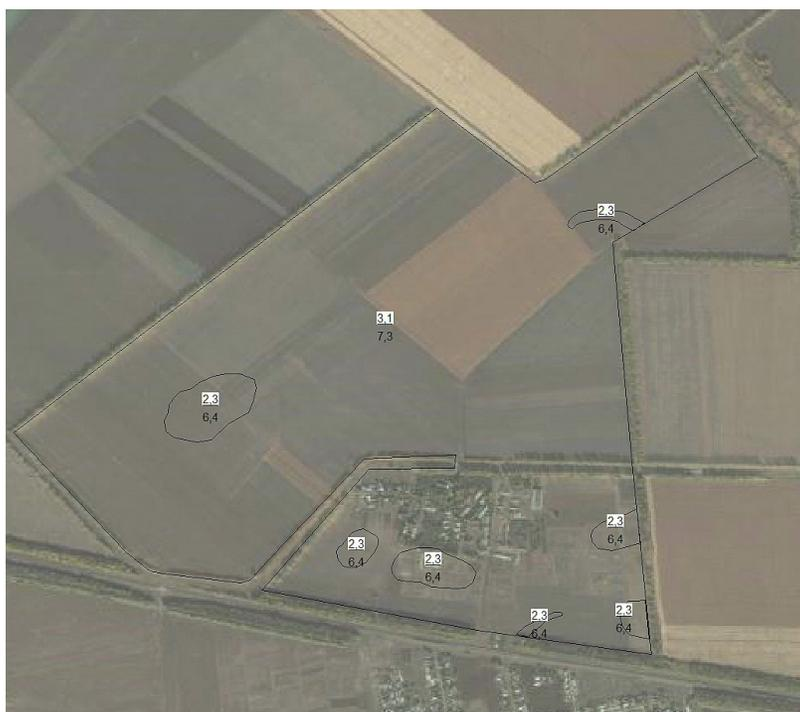
Рис. 4. Картосхема, на основе аэрофотосъемки (над чертой – содержание углерода органического вещества, %; под чертой –  $pH_{\text{вод}}$ . Замкнутые круги – микропонижения, установленные по результатам оперативной аэрофотосъемки)
