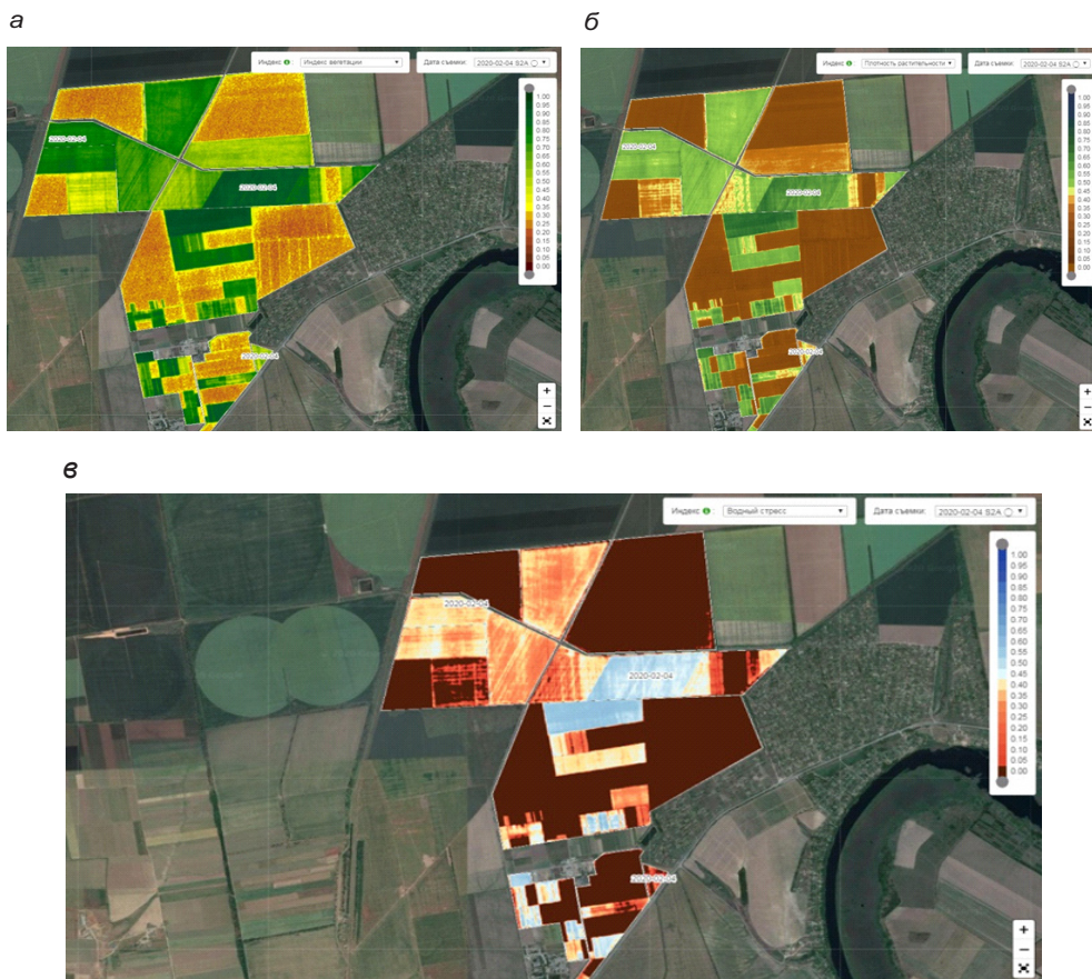
Рис. 1. Результаты анализа спектральной яркости участков опытного поля Института орошаемого земледелия НААН Украины по показателям вегетационного индекса (а), густоты стояния растений (б) и проявлению состояния водного стресса (в)
